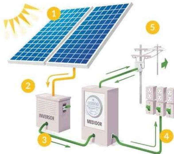
**Figura 3-6. Esquema de obtención de energía eléctrica por radiación solar**
